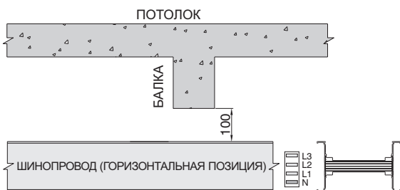
Рисунок 4. Проход под балкой на горизонтальном участке (шины «вертикально»)
