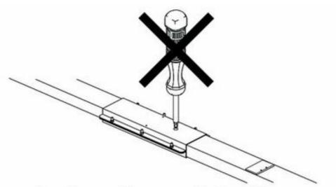
Do not remove the screw on the top of the cover. Non rimuovere la vite sulla parte superiore del coperchio.
